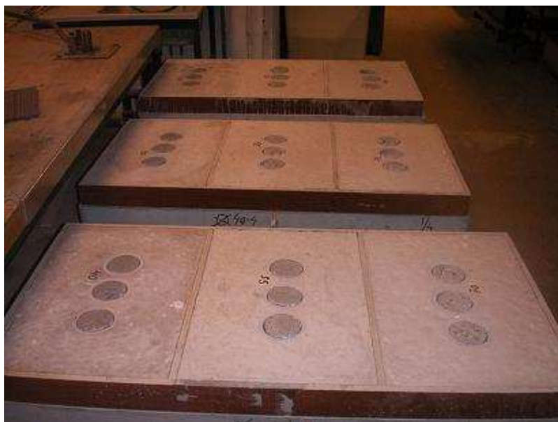
Figur 4 – Vidhäftning provades genom utdragsförsök. Totalt tre prov utfördes i varje pågjutningsdel.
